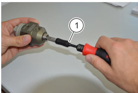
Rys. 18: Dokręcenie śruby uszczelniającej wkrętakiem dynamometrycznym
